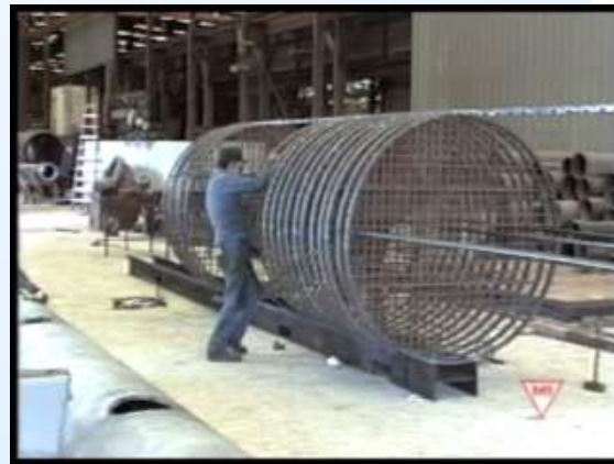
Rod Baffle Example
