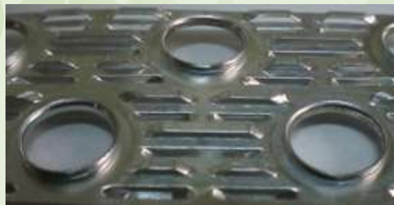
裂口式鰭片 — 雙向開口 (slit)
