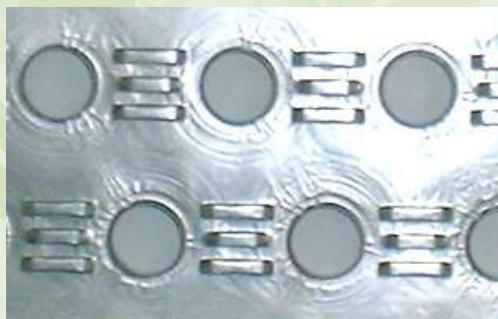
裂口式鰭片 — 單向開口 (slit)
